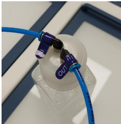
Kuva 23.1 Putkiliitäntä kosteutuspullossa ja MIRI® Humidity-monitila-IVF-inkubaattorissa
