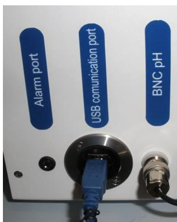
Kuva 20.1 BNC:hen yhdistetty pH-anturi
