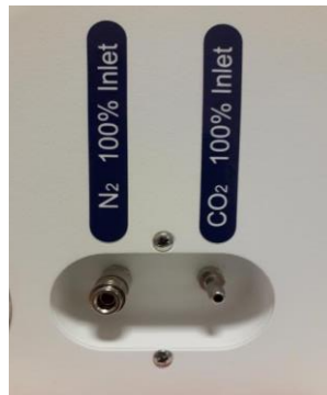
Kuva 11.1 Takana olevat kaasuntuloaukot MIRI®- ja MIRI® Humidity-monitila-IVF-inkubaattoreissa
