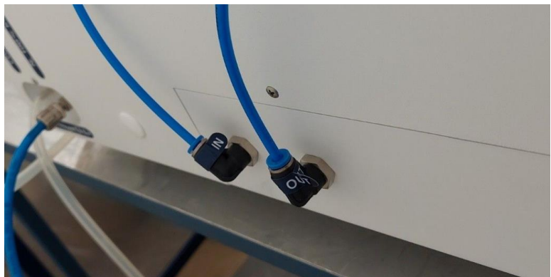
Kuva 23.1 Putkiliitäntä kosteutuspullossa ja MIRI® Humidity-monitila-IVF-inkubaattorissa
