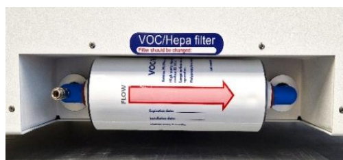
Kuva 12.3 Oikein asennettu VOC/HEPA-suodatin
